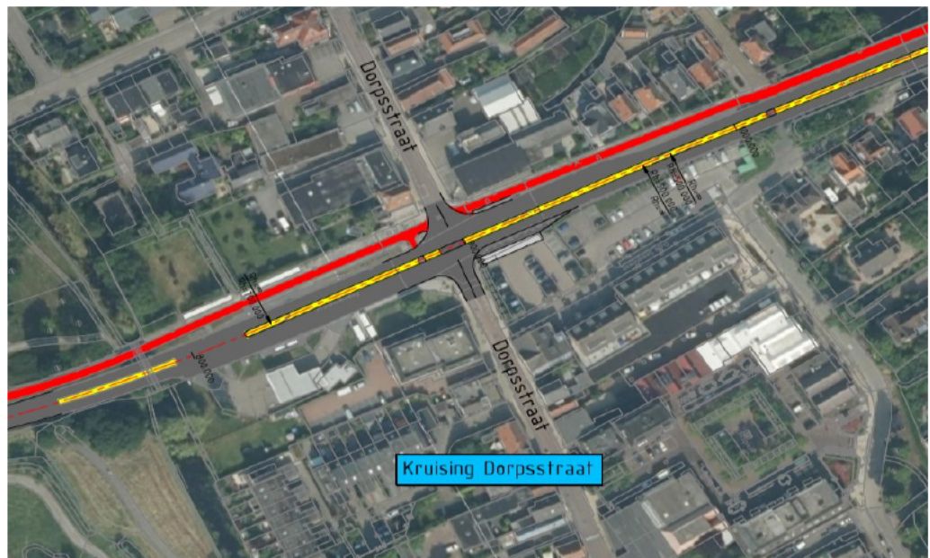
Figuur 10: Wegaanpassingen aan de kruising met de Dorpsstraat, waarbij afslaan naar links niet meer mogelijk is. Daarnaast komt er een nieuwe fietsoversteekplaats en wordt de bushalte verplaatst naar de noordzijde van kruising met de Dorpsstraat (variant X-robust).
