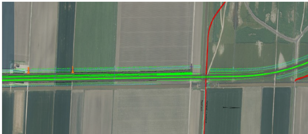
Figuur 2: Voorlopig wegontwerp (groen) voor de Verlengde Bentwoudlaan, inclusief een nieuwe parallelweg en fietspad (rood). De parallelweg moet toegang bieden tot landbouwpercelen.
