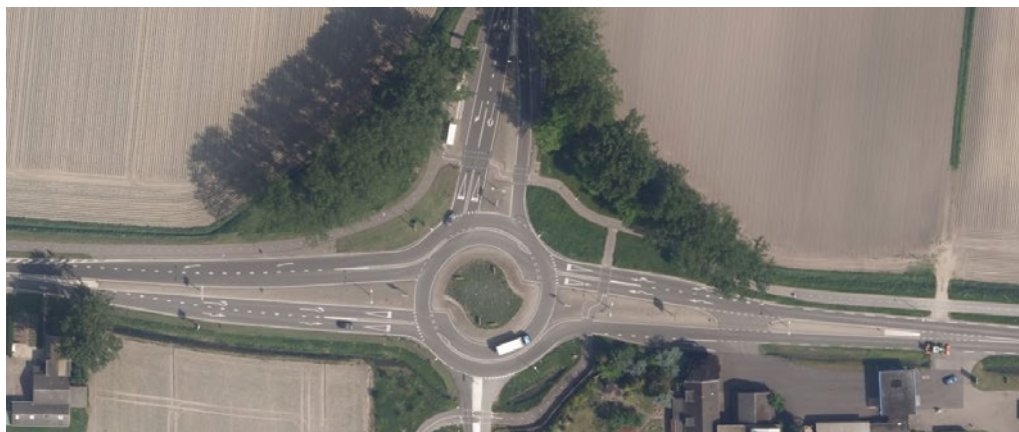
Figuur 26: Huidige (turbo)rotonde op kruispunt Hoogeveenseweg - N209 kan verkeersafwikkeling in 2035 niet meer garanderen
