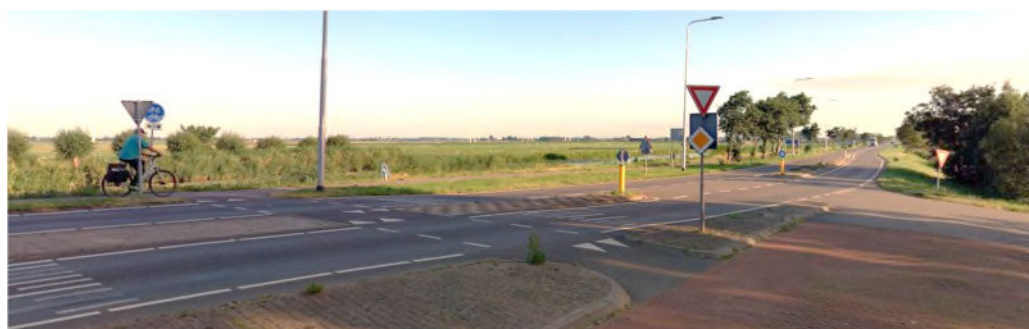
Figuur 9: Gelijkvloerse fietsoversteek over relatief drukke gebiedsontsluitingsweg (N209)
