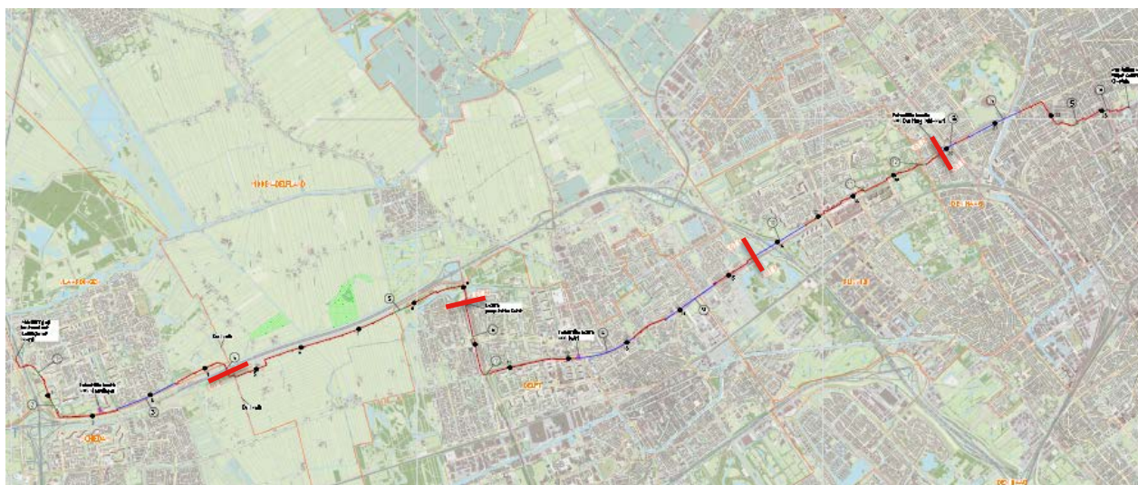
Figuur 3-2: Indeling van het tracé in loten. Indeling loopt van links(zuid) naar rechts(noord) (A t/m E). Om praktische redenen wordt de kaart vaak niet met het noorden, maar het westen naar de bovenzijde afgebeeld. Bron: Rotterdam Engineering.
