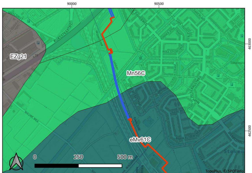
Afbeelding 8. Uitsnede van de bodemkaart van Nederland met het plangebied. Aanleg door middel van open ontgraving = rode lijn, aanleg door middel van sleufloze technieken = blauwe lijn. (bron: Esri & Partners).
