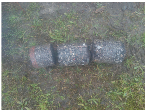
Fotonummer: 27 Omschrijving: Asfaltkernen boring A017
