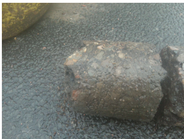
Fotonummer: 33 Omschrijving: Asfaltkern A022 (0,23 – 0,36 m -mv)
