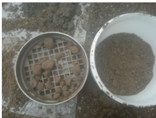
Fotonummer: 4 Omschrijving: Traject 0,30-0,50 m -mv bij boring 016
