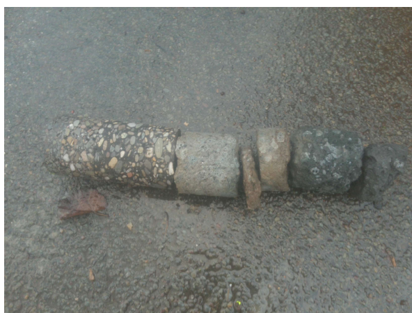
Fotonummer: 23 Omschrijving: Asfaltkernen incl. fundering A013
