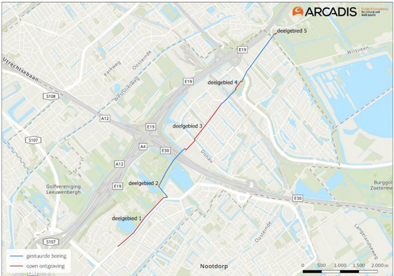
Figuur 2. Het plangebied in 2021 met daarin onderscheid tussen gestuurde boringen (blauwe lijn) en de vijf deelgebieden waar een open ontgraving plaatsvindt (rood). Bron: Arcadis, 2021.
