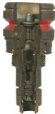
Afb. 5.1.2.1. – Chemisch lange vertrager No.37 UK met anti demonteerinrichting
