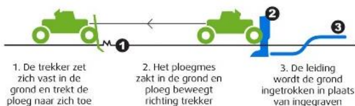
Figuur 3-3 Schematische weergave inploegen (Gasunie)
