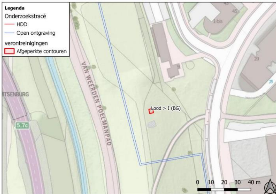
Figuur 7-2 Indicatieve ligging van de sterke verontreinigingen buiten het werkgebied ter plaatse van de Laan van Heemstede/het ILSY-plantsoen.
