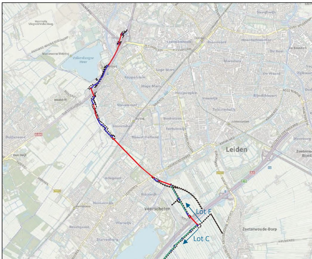
Figuur 1.2: Ligging tracé met specificatie van de aanleg methode (rood: HDD; blauw: open ontgraving; groen: inploegen) en met weergave van tijdelijke werkstroken, toegangswegen en werkerterreinen (zwarte stippellijn). Bron ondergrond: TopoPlus
